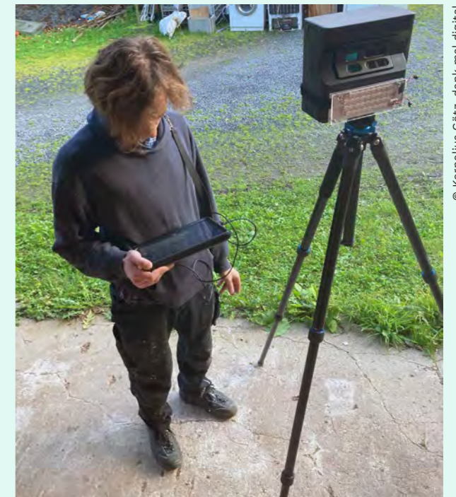
Dreidimensionale Dokumentation mit einem 3D-Scanner Three-dimensional documentation using a 3D-scanner
